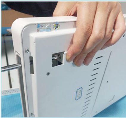
2. 将里面的螺丝拧开，取下后盖。
